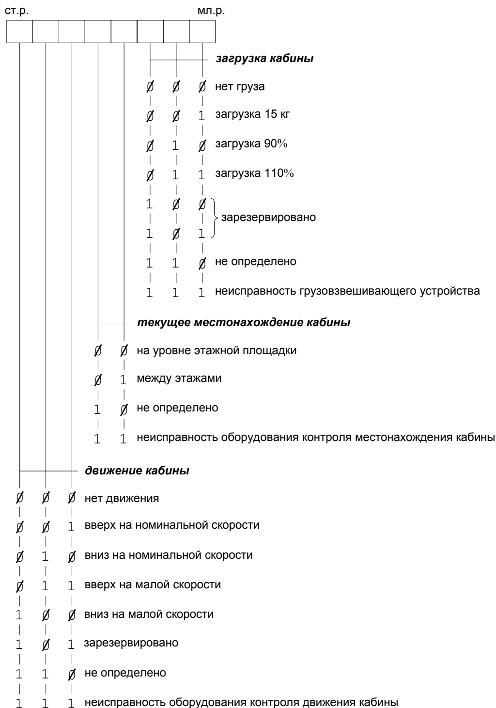
Рисунок Г.5 Идентификатор состояния кабины
