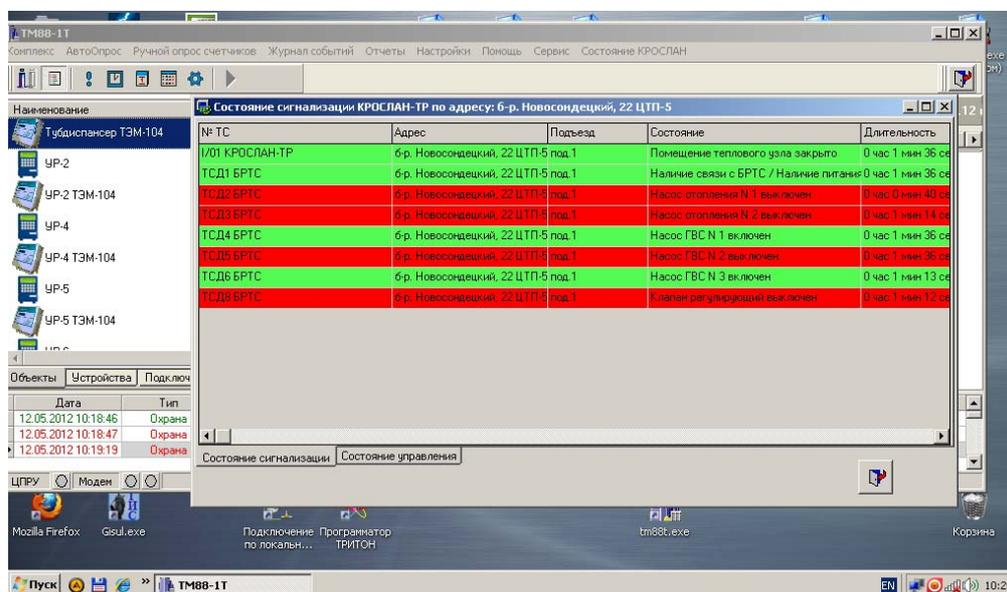
Аналогично может быть реализована диспетчеризация блочных и крышных котельных, а также трансформаторных подстанций. Ниже приведены функциональные характеристики таких систем. В такой конфигурации требуемые параметры давления и температуры в трубопроводах снимаются с теплосчётчика и газосчётчика, контроль температуры в помещении трансформаторной подстанции производится с помощью сигнализации от температурных реле, настроенных на заданные значения.
