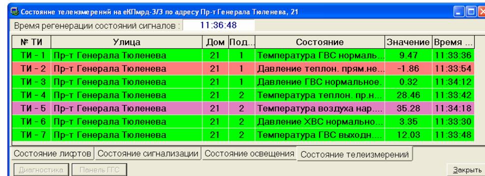
Перейдите на вкладку «Состояние телеизмерений». По каждому телеизмерению можно прочитать его адрес, текущее состояние и значение телеизмерения. Также можно узнать время последнего
