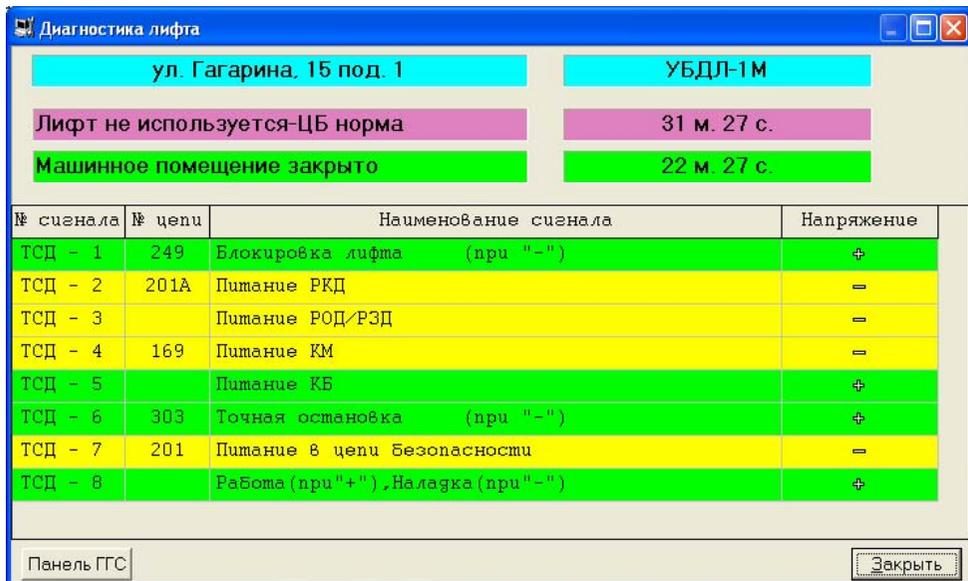
На данной панели можно определить состояние дверей шахты и кабины, режим работы (работа или наладка) и т.д. Символ "+" в графе "Напряжение" показывает наличие напряжения в диагностируемой цепи, символ "-" - отсутствие напряжения. Информация о наличии либо об отсутствии напряжения появляется с небольшой (4...6 сек) задержкой относительно времени запуска диагностики. Результаты диагностики помогут электромеханику оперативно определить причину неисправности лифта.
