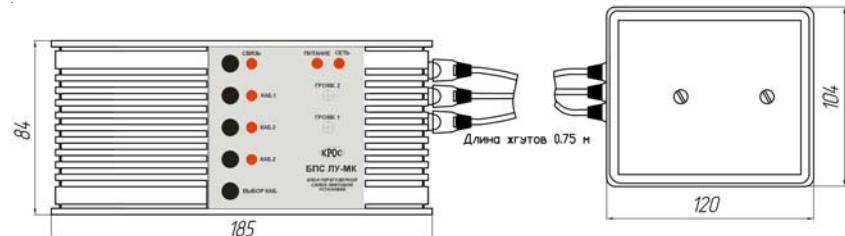
1.4.1.1. Блок БПС ЛУ-МК комплектуется распределительной коробкой КРТП15х2, подключаемой к БПС ЛУ-МК через разъёмы RJ45. К распределительной коробке через линии связи подключаются переговорное устройство купе кабины лифта и по условиям применения переговорное устройство крыши кабины УП-КК. Непосредственно к БПС ЛУ-МК через внутренний клеммный соединитель подключается сетевой адаптер и аккумулятор (при необходимости).
